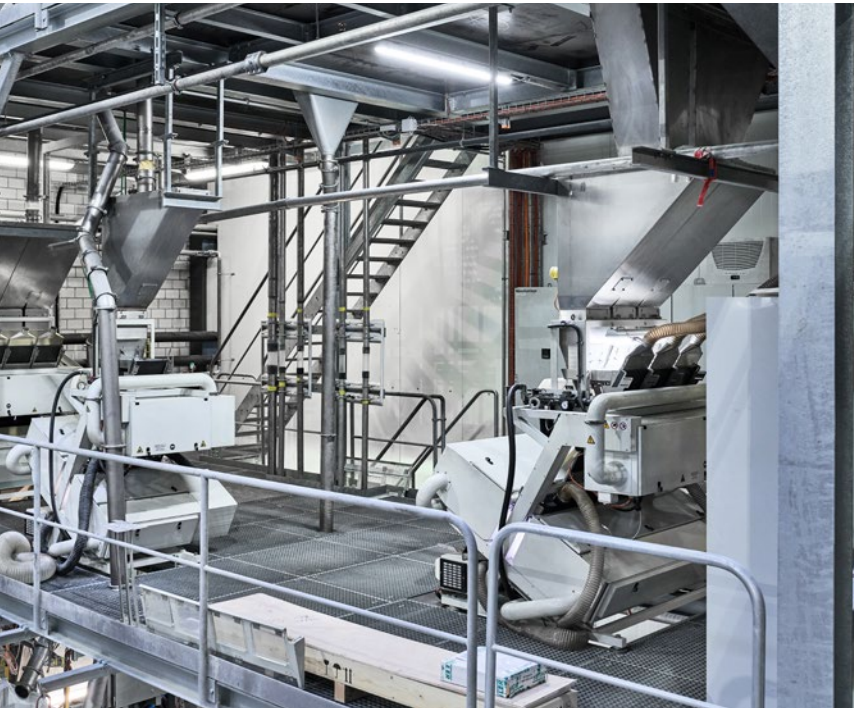
Der «Flakesorter» überprüft mit modernsten Sensoren jedes einzelne PET-Flake auf seine Qualität.
